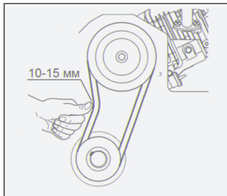
Рис. 23 Проверка натяжения ремня привода вибратора
